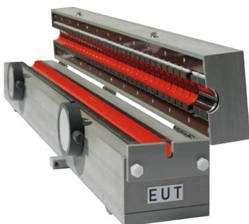
MDS 21B, Ansicht zur EUT-Seite der geöffneten Zange
